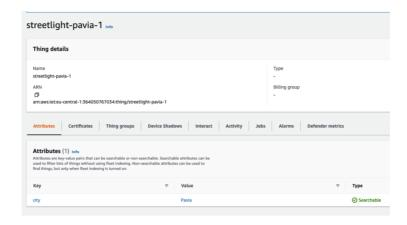
Nella fase di creazione degli oggetti sarà necessario scaricare i certificati associati ad essi. I certificati verranno utilizzati dal dispositivo stesso per poter inoltrare messaggi sui topic MQTT. In questo articolo non entreremo nel dettaglio delle varie modalità con cui è possibile scaricare i certificati sul dispositivo, per ora ci limitiamo a considerare il caso di dispositivi già presenti sul campo e dotati di certificati.
