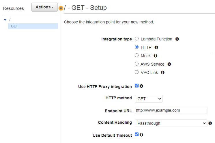
A questo punto, API Gateway può diventare l'unico punto di accesso dell'applicazione. Dovrebbe essere possibile azionare il DNS per puntare il dominio al nuovo punto d'ingresso e vedere tutto il traffico fluire attraverso il Gateway senza che sia necessaria alcuna modifica dell'applicazione.
