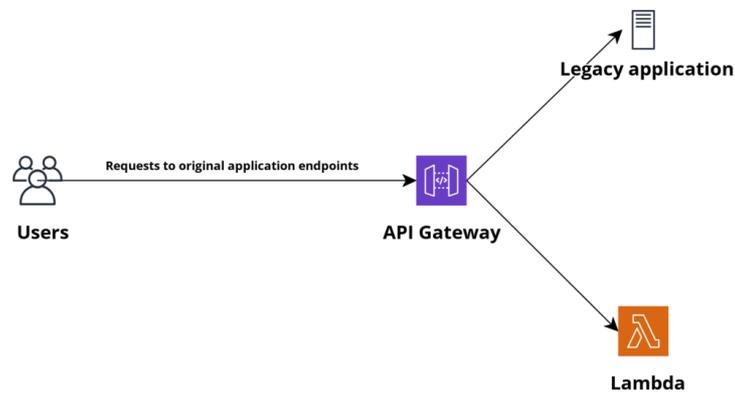
Una volta mappati tutti gli endpoint all'API Gateway, è necessario configurarlo per proxare l'infrastruttura dell'applicazione corrente. Per farlo, possiamo usare un'integrazione specifica chiamata "HTTP", per la quale è necessario abilitare l'opzione proxy come mostrato nell'immagine seguente.
