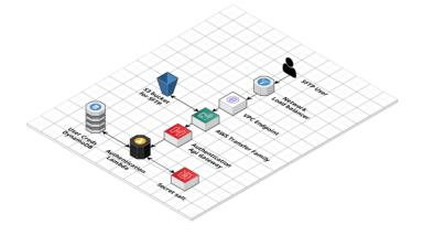
Come puoi vedere dallo schema, abbiamo dovuto introdurre un paio di servizi che non avevamo previsto, come un Network Load Balancer e un VPC endpoint. Questi due componenti sono necessari per assicurarsi che gli IP esposti siano fissi e non cambieranno mai. In questo modo, infatti, è possibile allocare un elastic IP, consentendo anche di importare indirizzi IP di tua proprietà (BYOIP). Questa funzione è comunemente richiesta per problemi specifici con alcune regole di firewall.
